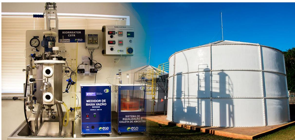
O reator CSTR operou com volume útil de 10 litros, compostos por uma mistura de inóculo, este, obtido no Laboratório de biogás, resíduos de alimentos
