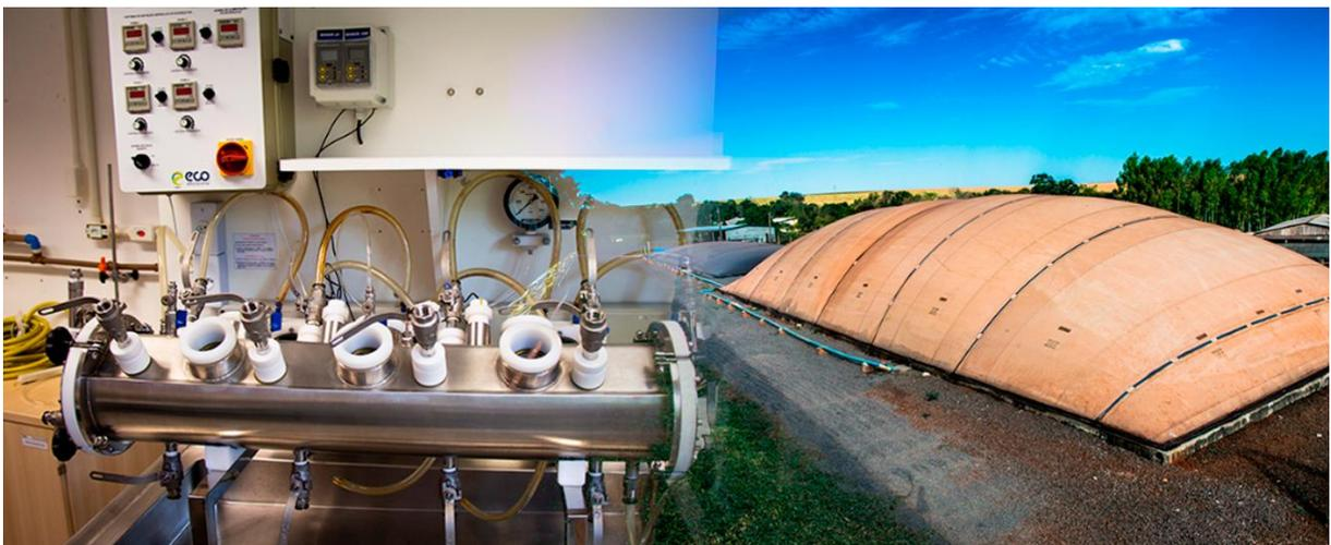
O reator BLC operou com volume útil de 8,0 litros, com a inoculação realizada por uma mistura composta por 80% de efluente de suinocultura bruto e 20% de inóculo, este, obtido no Laboratório de biogás. Foram fixadas e controladas as
